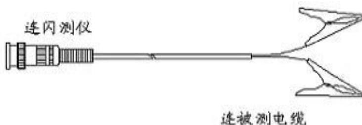
图7. 连接电缆示意图
