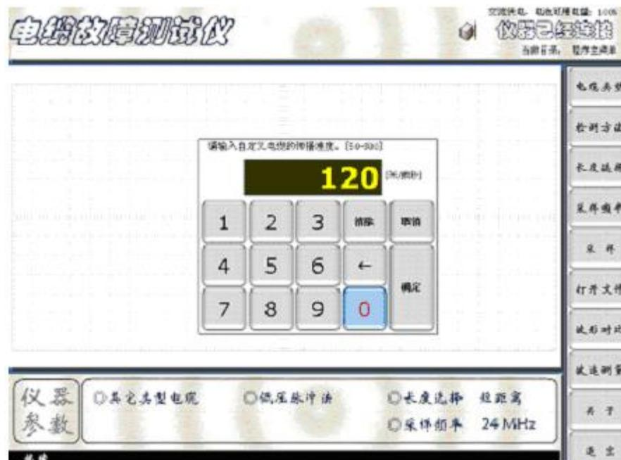
步骤阅读图十四 电缆波速传播速度输入界面
