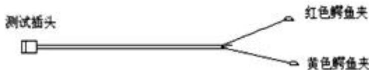
测试导引线的末端一共带有二个鳄鱼夹（红夹子/黄夹子）。
