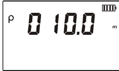
设定完  $a$  值后, 在土壤电阻率测试模式下, 按 “**TEST**” 键开始测试, 并倒计时显示测试进度, 完成测试后显示稳定的土壤电阻率值。
