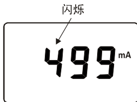
图14. 电流报警临界值设定
