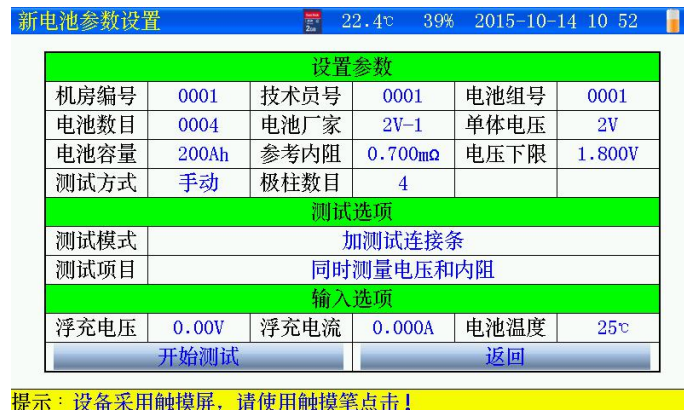
图 3.2.1-1 新电池参数设置界面
