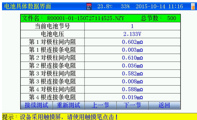
图 3.5.4-2 每节电池详细测试数据界面
