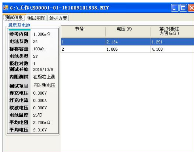
图 4.4 电池组设置参数及测试数据
