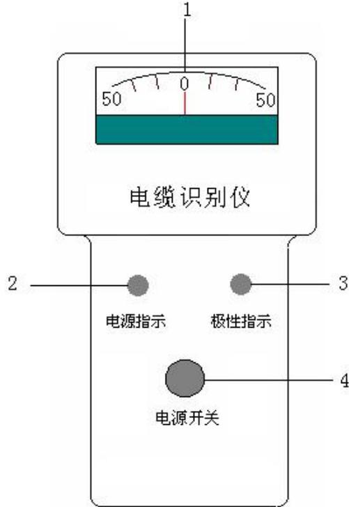
图 3-2 电缆识别仪接收机面板图
