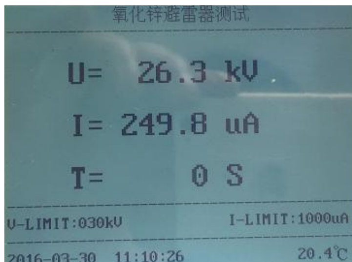
图 12 氧化锌避雷器 0.75 I_{mA} 降压
