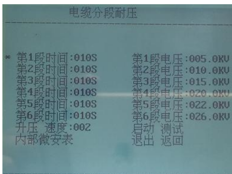
图 14 电缆分段耐压参数设置界面
