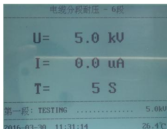
图 16 电缆分段耐压第一段计时
