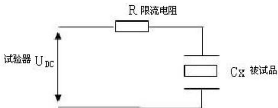
图 9 限流电阻使用示意图
